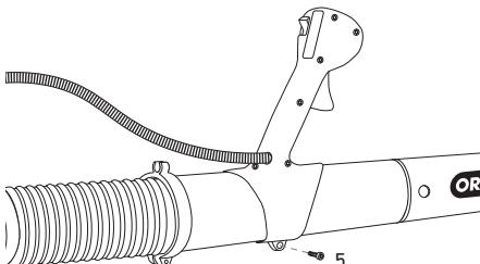
6. Fije el cable del acelerador dentro de los ganchos, en los dos sujetadores de la manguera (6).
