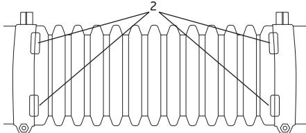
3. Insérer le tube d'insonorisation avec la bague collectrice dans le tuyau plissé (3). Fixer avec le second collier de serrage du tuyau, orienter les marqueurs d'alignement et serrer la vis de serrage. Ajuster la tension de la vis de serrage du tuyau pour garantir la libre rotation de l'embout.
