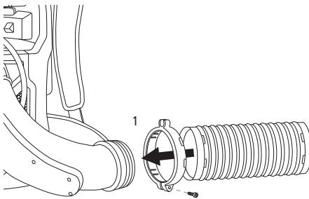
2. Orienter les marqueurs d'alignement face à face (2). Insérer et serrer la vis du collier de serrage du tuyau.
