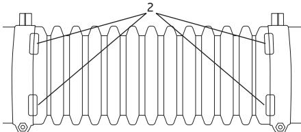
3. Inserte el tubo de amortiguación de sonido con el anillo deslizante dentro de la manguera plegada (3). Fije con el segundo sujetador de la manguera y, al mismo tiempo, oriente los marcadores de alineamiento y ajuste el tornillo del sujetador. Ajuste la tensión del tornillo del sujetador de la manguera para asegurarse de que la boquilla pueda rotar libremente.
